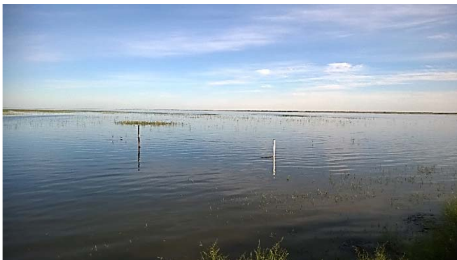
На фото - рейки для мониторинга уровня воды в озере Рыбачье (июнь 2017)
