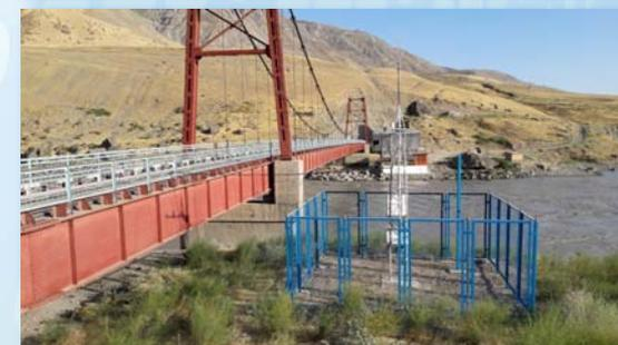
АГП измеряют и передают в Центр сбора данных (ЦСД) данные об уровне воды, температуре воздуха и воды. На гидрологическом посту наблюдателем в АРМ вручную вносятся результаты инструментальных и визуальных наблюдений, а именно, осадки, высота снежного покрова, состояние водного объекта и результаты измеренных расходов. Автоматическая станция передает результаты измерений в ЦСД и на АРМ. С АРМ данные автоматических, инструментальных и визуальных наблюдений передаются в ЦСД.
